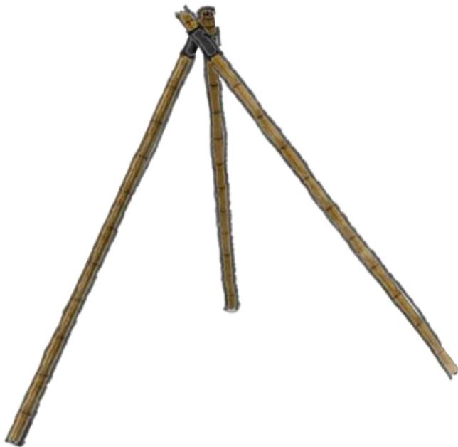
**2** Montar 2 triángulos con 3 varillas de bambú cada una amarrándolas en las extremidades.
